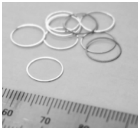
アルミリング 内径φ9.2 外径φ10.0 厚さ0.3mm ワイヤ放電加工により作製
