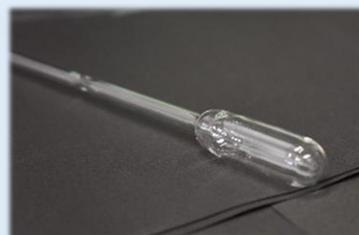
製作したアンプル管。液体を封入できるように管の一部が狭くなるよう加工されています。細い管と太い管をバーナーで接続して製作します。
