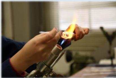
ガラス細工に使用するバーナーには可燃性ガス・酸素・圧縮空気の3つが送られており、それらを細かく調整しながら作業を行います。また先端のノズルは円形で、中心部分と円周部分の炎が別々に調整できるようになっており、広く加熱するための大きな炎、局所的に加熱するための小さな炎を作り出すことができます。
