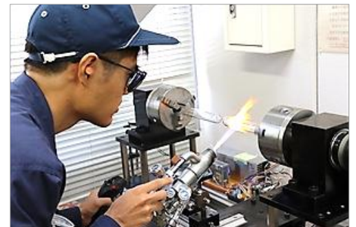
自作ガラス旋盤の使用感を確認する越山氏（計測・分析技術室）
